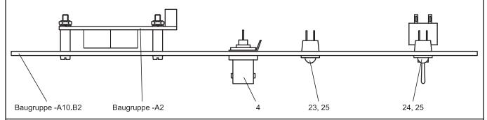
Maß "X" richtet sich nach den verwendeten Bauelementen. Die Positionsnummern beziehen sich auf die Seiten 4 und 5. Die Bauelemente in der Frontplatte dürfen montiert, jedoch **nicht** vorverdrahtet werden (Ausnahme: -A10.S1, siehe hierzu die Informationen in den Standard-Bereitstellungsunterlagen).
