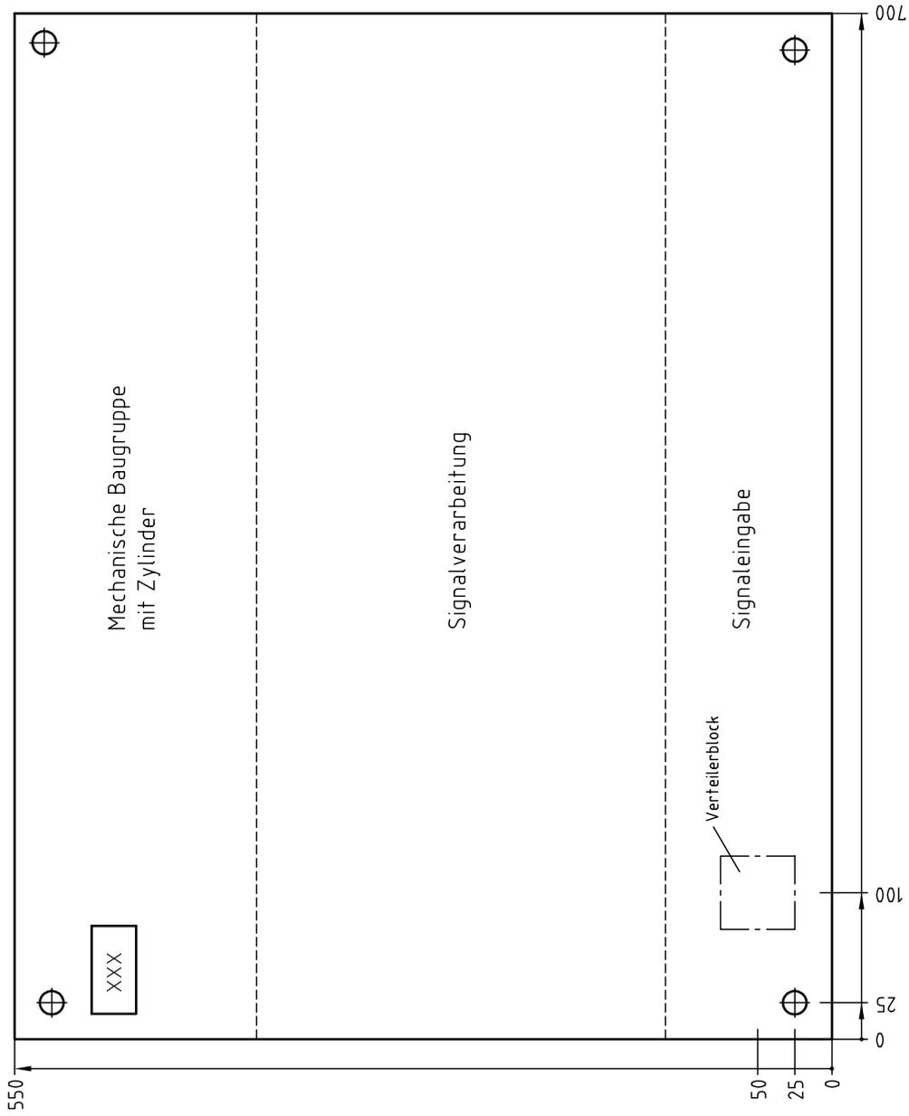
Verteilerblock wahlweise links oder rechts montiert
