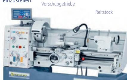
Die Größe einer Drehmaschine wird durch die Spitzenhöhe und die maximale Drehlänge festgelegt. Die Spitzenhöhe ist der Abstand von der Oberkante des Maschinenbetts zur Mitte der Arbeitsspindel bzw. Reitstockspitze. Die maximale Drehlänge ist der Abstand zwischen Stirnseite Backenfutter und Reitstockspitze in der hinteren Endlage des Reitstocks.
