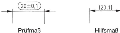
Kennzeichnen Sie das Maß der Bohrung der nachstehenden Zeichnung so, dass ein Facharbeiter weiß, dass es sich um ein Prüfmaß handelt.
