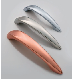
Bild 125: Türgriff für ein Fahrzeug aus ABS in den drei Beschichtungsstufen verkupfert, vernickelt und verchromt (von unten nach oben) (Bild: Atotech)
