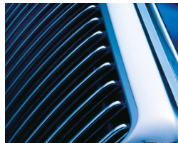
Bild 126: Zierteile wie Kühlergrills oder Emblems erhalten durch die Metallisierung ein Aufwertung (Bilder: Atotech)
