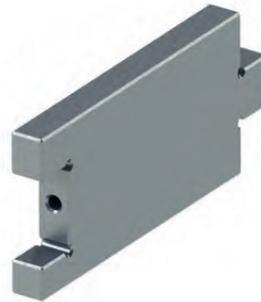
Feile zuerst die Fläche 84 (74) mm x 8 mm eben und winklig. Die Ebenheit mit dem Haarlineal nach dem Lichtspaltverfahren prüfen. Die Winkligkeit zur Plattenfläche (74 mm x 38 mm) mit dem Haarwinkel prüfen.
