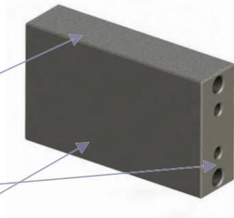
Zuerst feilst du bitte die Fläche 64 mm x 16 mm eben und winklig. Die Ebenheit mit dem Haarlineal nach dem Lichtspaltverfahren prüfen.
