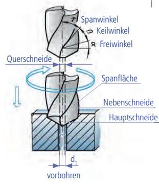
Arbeitsstufen beim Bohren
