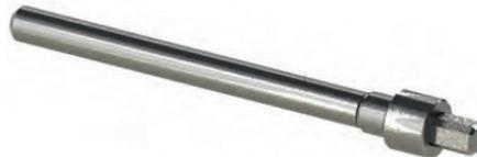
Die Gewindespindel gehört zur Höhenverstellung. Einmal wird mit ihr der Schlitten aus Baugruppe Pressenaufnahme gegen Herunterfallen geschützt, wenn die Klemmung der Baugruppe Pressenaufnahme gelöst ist. Zum anderen wird damit die Positionshöhe der gesamten Baugruppe 3 und damit die „lichte Weite“ der Presse eingestellt. Mit der Deckplatte gibt es eine Gleit(lager)verbindung. Die Passung muss sehr genau stimmen, damit eine einwandfreie Funktion gewährleistet ist.
