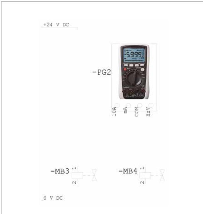
**Bild 5** Gesamtstrom messen in der Parallelschaltung
