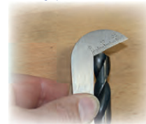
Prüfung Spitzenwinkel ohne Lehre
