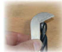
Prüfung Spitzenwinkel ohne Lehre
