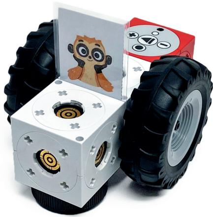
Eine Leitfigur ausschneiden und zwischen dem weißen Modul und den Motor stecken. Wenn es möglich ist, kann die Karte mit der Leitfigur auch laminiert werden.
