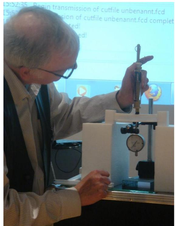
Natürlich sind auch Prüfungen von fest eingespannten Profilen und Messungen von Stauchung und Streckung zur Erklärung des Materialverhaltens möglich.
