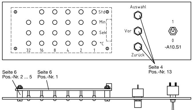
Die Maße "X" richten sich nach den verwendeten Bauelementen. Die Bauelemente in der Frontplatte dürfen **nicht** vorverdrahtet werden (Ausnahme: -A10.S1, siehe hierzu die Informationen in den Standard-Bereitstellungsunterlagen).
