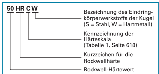
Bild 2: Normgerechte Angabe eines Rockwell-Härtewertes (Beispiel)
