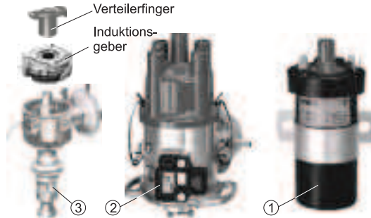
Wesentliche Bauteile der TSZ-i mit Steuergerät am Zündverteiler
